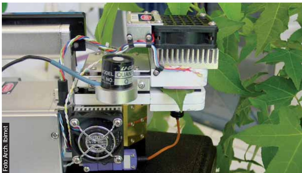
Strumentazione utilizzata per misurare gli scambi gassosi dalle foglie delle piante analizzate.
